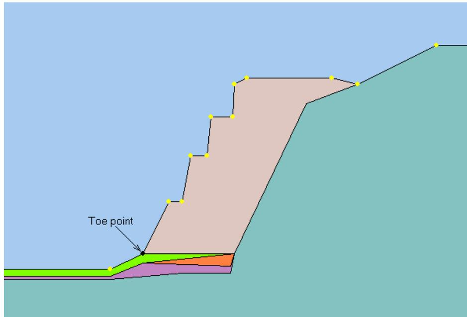
Il materiale che costituisce il corpo rinforzato è rappresentato da terreno granulare non a spigolo vivo, poi si hanno strati di argilla alternati fino alla roccia sottostante.
