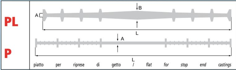
Per giunti di ripresa con **pressione idrostatica da bassa a media**
