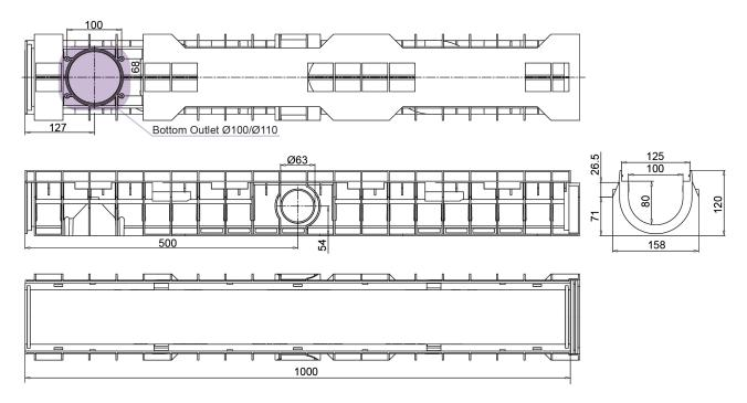
Tenuta all'acqua: per assicurare la tenuta stagna delle canalette, si consiglia l'utilizzo di un adesivo sigillante bituminoso. A garanzia completa e duratura dell'assenza di perdite attraverso i giunti delle canalette, si può provvedere alla saldatura a caldo dei giunti stessi.
