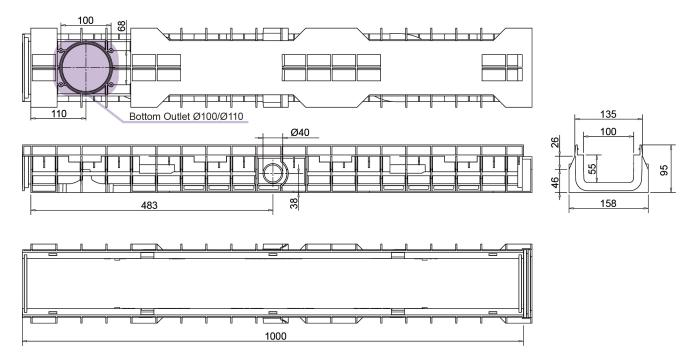
Tenuta all'acqua: per assicurare la tenuta stagna delle canalette, si consiglia l'utilizzo di un adesivo sigillante bituminoso. A garanzia completa e duratura dell'assenza di perdite attraverso i giunti delle canalette, si può provvedere alla saldatura a caldo dei giunti stessi.
